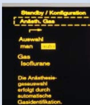
Die Narkosegaserkennung erfolgt beim Julian automatisch
